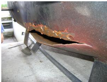
Figura 7: Estricção da zona da fratura.
