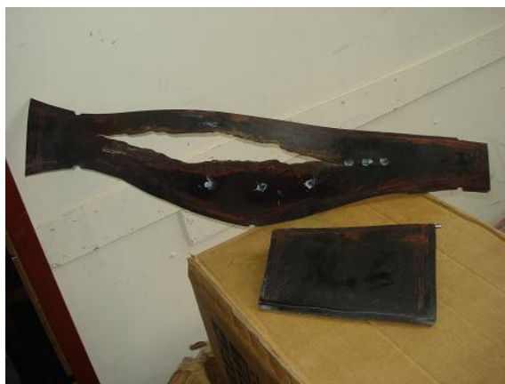
Figura 10: Peças cortadas do vaso para análise.
