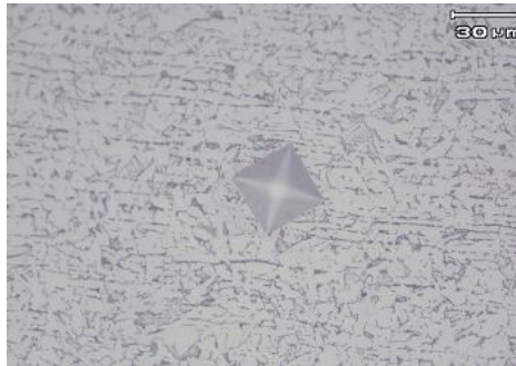
Figura 15: Foto da peça após teste de dureza Vickers (500x).
