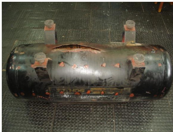
Figura 2: Vaso após rompimento no teste hidrostático.
