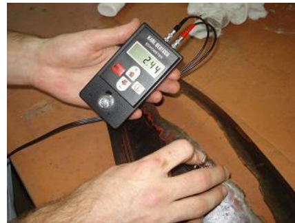
Figura 8: Medição de espessura na região da fratura.
